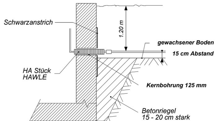
Die Hauseinführung wird durch die WVR zugewossen. Zwecks zusätzlicher Abdichtung ist um die Hauseinführung aussen, ein Schwarzanstrich (bauseits) aufzubringen.
